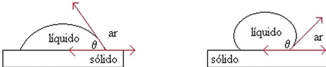
**Figura 7:** Ângulo de contato  $\theta$  da gota com superfície sólida.
